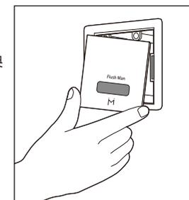
③ 外部枠に設けられたマグネットに合わせ、センサーユニットを吸着させて取付ける。
