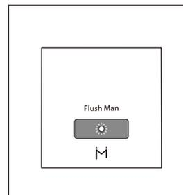
乾電池が消耗すると、赤ランプが1秒ごとに点滅しますので速やかに電池を交換してください。
