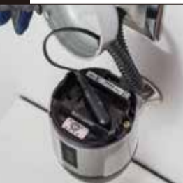
本体上部にある電源コネクタにL字プラグを差し込む
