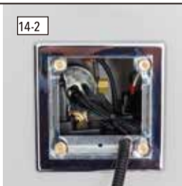
チューブを前に引っ張っても抜けないように均等に設置する。
