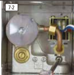
電磁弁を固定している取付ネジを数回転緩める。またアース線固定ネジを外す。 ※ネジは手順8で使用しますので紛失しないようご注意ください。
