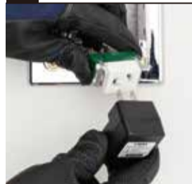
ACアダプタをソケットに差し込む。※必ず同梱のACアダプタを使用してください。
